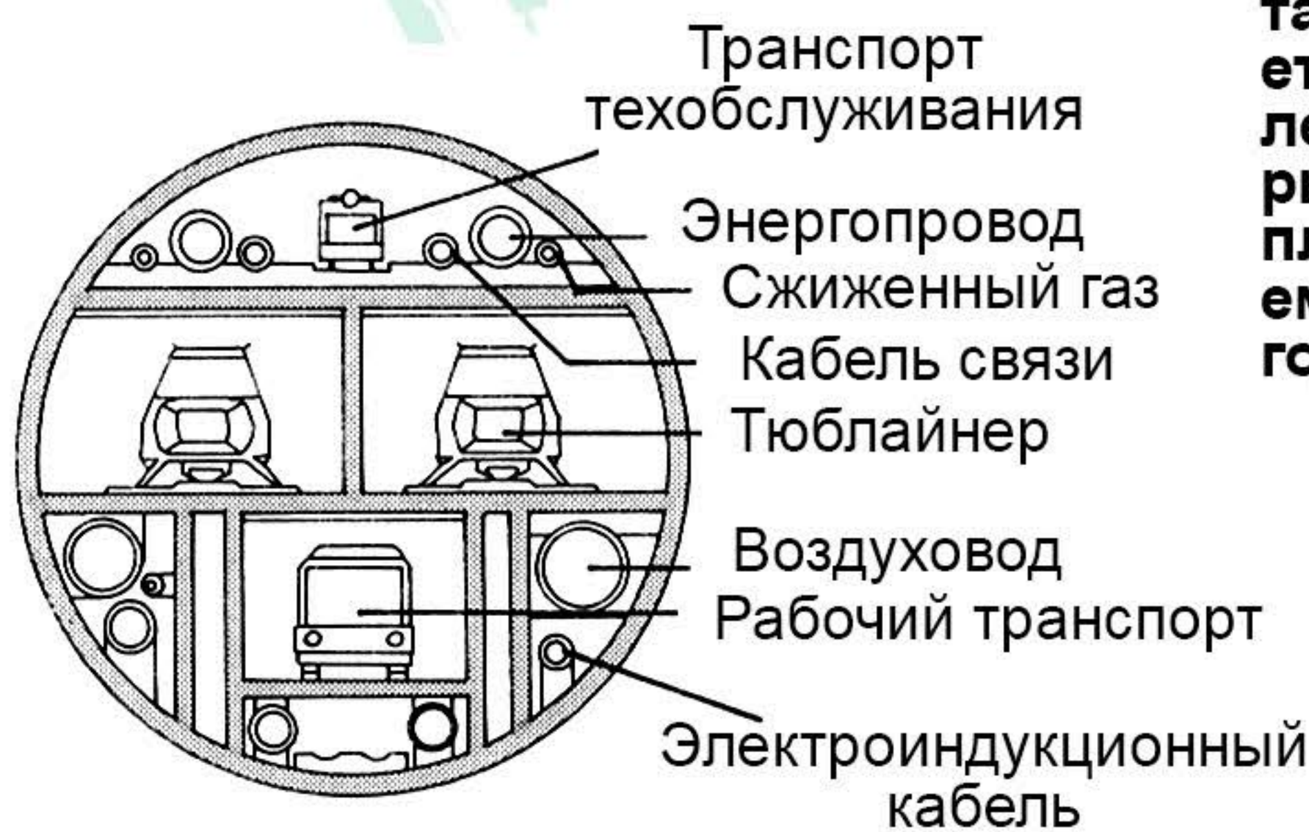
Схема поперечного сечения туннеля Тюблайнера
